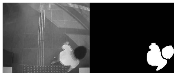
Fig.1 Left: Input image, Right: Detected Moving object 一方、移動物体領域と背景とは画素値の相関が弱い。したがって、画素値の相関値を算出し、その値が設定した閾値よりも高ければ影と判定できると考えられる。
