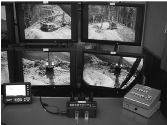
図1 無人化施工の操作インタフェース ((株) 熊谷組提供)
