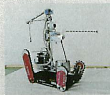
写真-2)福島で活躍するロボット：クインス このクインスを遠隔操作し原子力発電所内部の映像を取得、さらに線量計をロボットに搭載して放射線量を測定し放射線マップを作成した。(千葉工大吉田智章氏提供写真)
