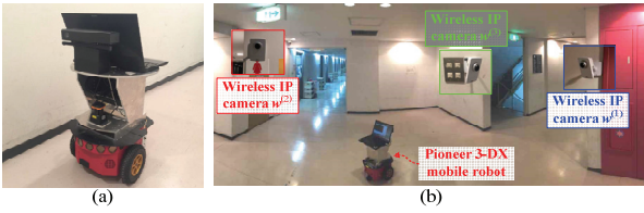
그림 8. 실험 장치: (a) Pioneer 3-DX 이동 로봇, (b) 카메라 센서 네트워크를 구축한 실험 환경.
