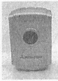
図3 網膜チップカメラモジュール Fig. 3. Artificial Retina LSI with Lens
