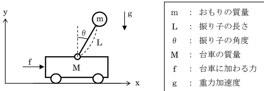
図1 倒立振り子システム
