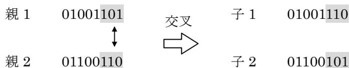
(ii) 多点交叉法：染色体内で切断する遺伝子座をランダムに  $n$  箇所指定し、それらの箇所では親の遺伝子を交換します。
