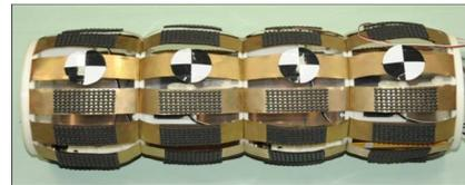
Fig. 1 Earthworm robot.<sup>(8)</sup>
