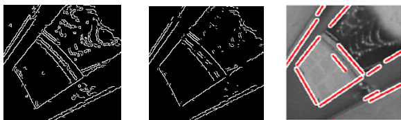
(a)エッジ点 (b)コーナー点除去 (c)直線
