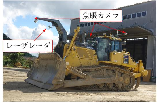
図 6 実機実験に用いた機体
