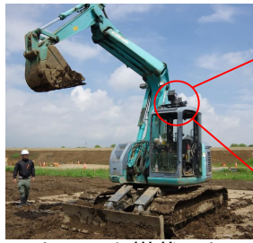
カメラを搭載した 建設機械
