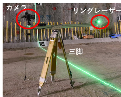
図 2 光切断法による計測装置の概要
