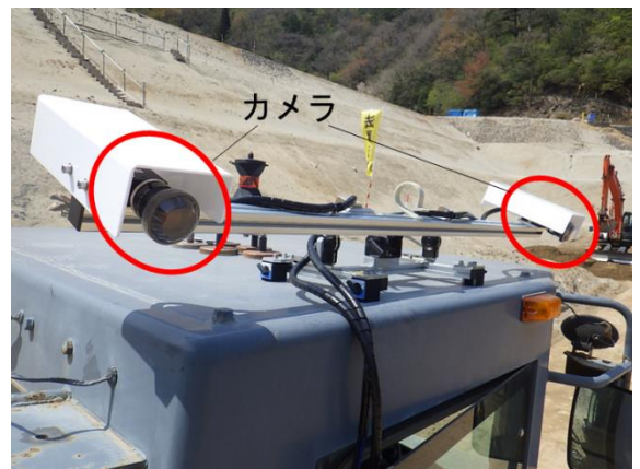
写真-1 ステレオカメラ設置状況
