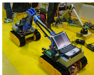
瓦礫上情報収集用牽引 ロボット "HELIOSキャリア" (東工大/東北大/電通大)
