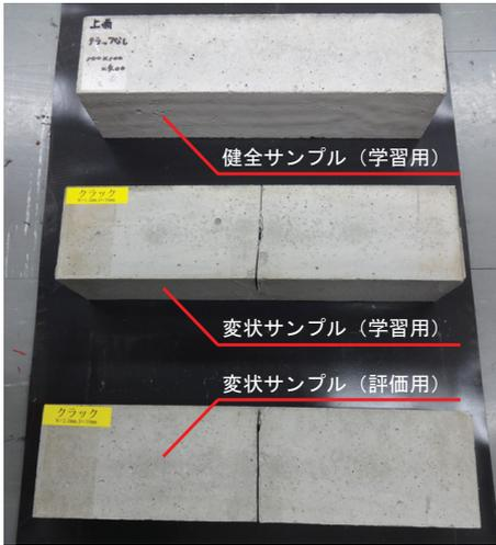
図 3 実験に用いたコンクリート試験体
