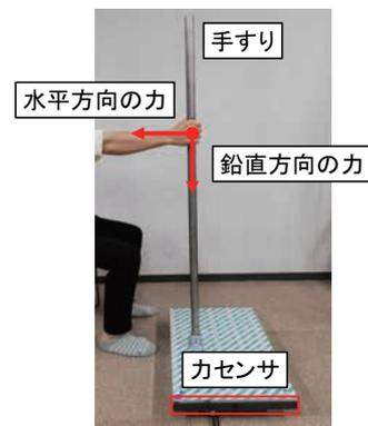
図1 起立時にかかる力を計測する鉛直方向の手すり
