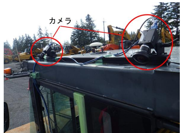
写真-1 カメラ設置状況
