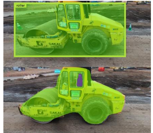
写真-3 AIによる物体検出 (上 : YOLO, 下 : Mask R-CNN)
